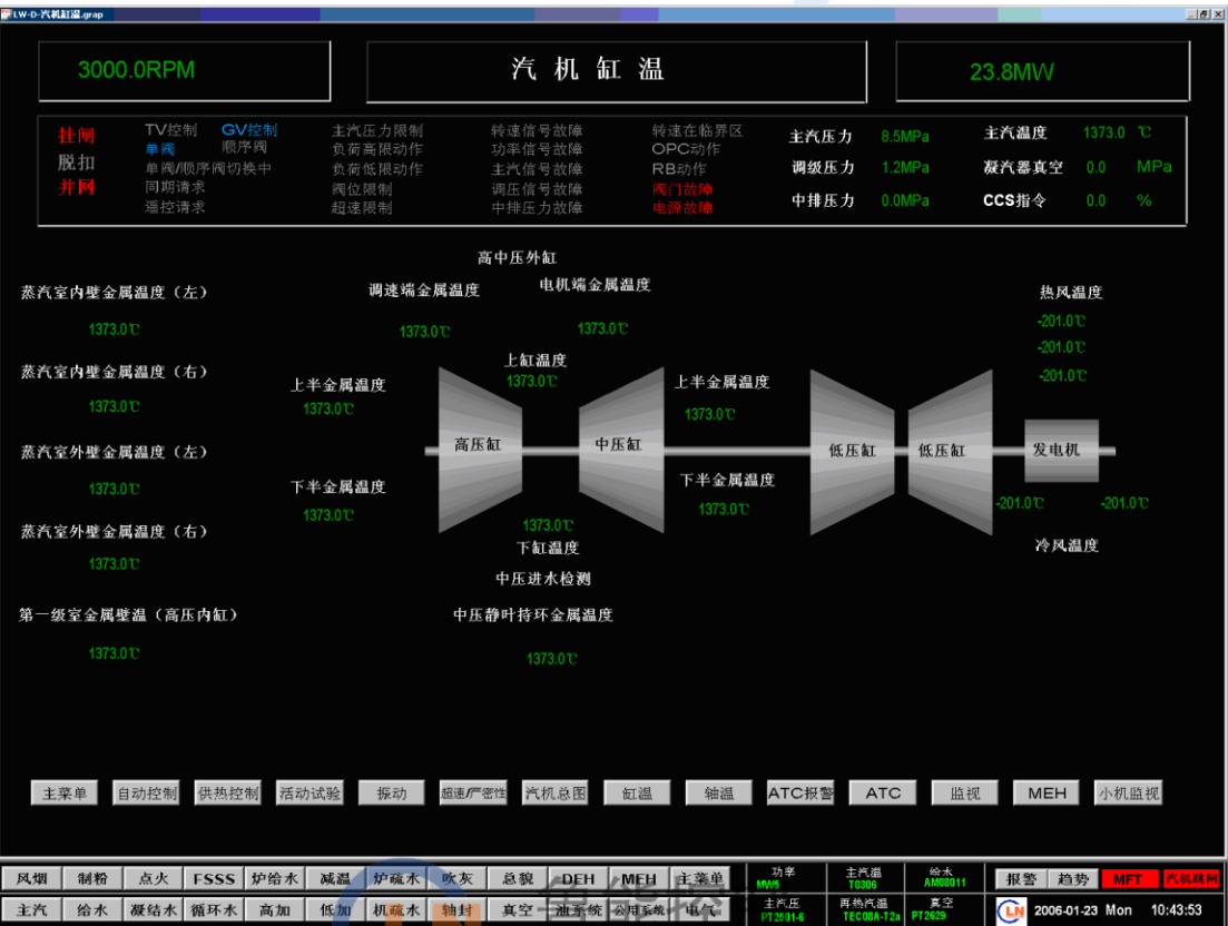
图 8-4-7 汽机缸温监视界面
