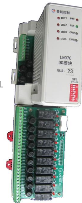
图 2.3.7-1 LN-07 DO 模块和继电器板相连效果图
