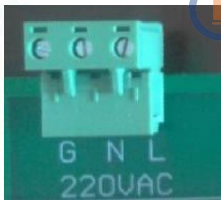
图 4 为 LK200-A 供电电源接线端子,其输入为交流 220V (每台前端的功耗不超过 5W),三个端子从左至右依次为接地线、零线和火线。另外,在接入电源线时应注意其极性必须与端子标示一一对应,防止接反损坏前端。
